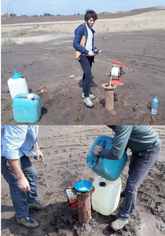
Fig. 7. Étude hydrogéologique du site. Mesures de l'eau souterraine (piézométrie, salinité, température et conductivité) et tests d'injection (S. Pistre, Th. Navarro).
