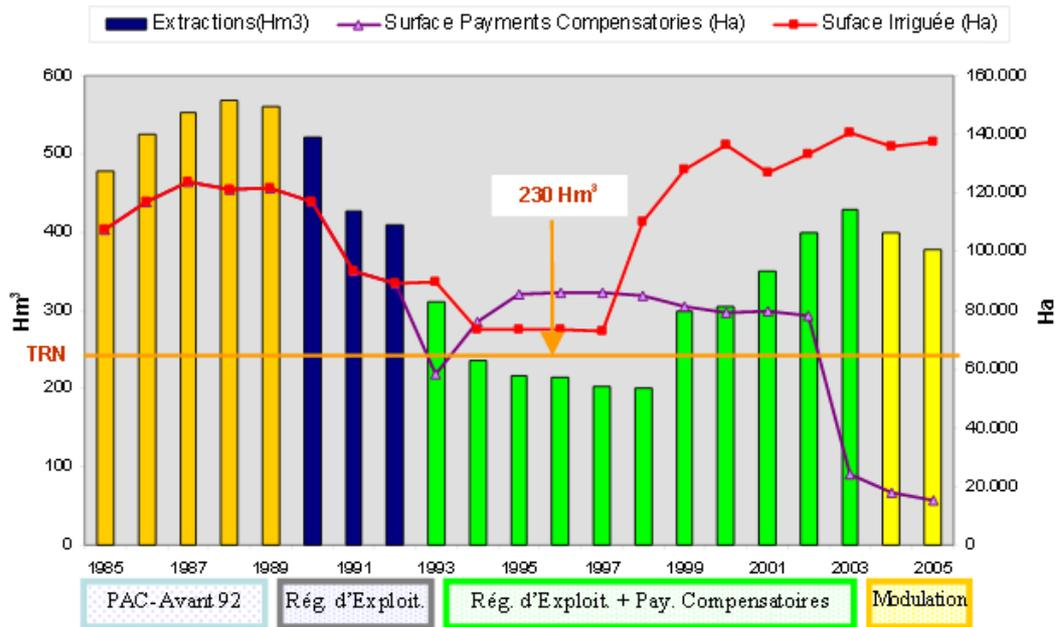
NRR : taux naturel de recharge de l'aquifère- « *natural recharge rate* » (230 Hm<sup>3</sup>). PAC-Avant 92 : politique agricole commune avant de la réforme de 1992. Rég. d'Exploit. : politique de quotas mise en place par le gouvernement central en 1991. Rég. d'Exploit.+Pay.compensatoire : programme agro-environnementale plus le système de quotas précédent. Modulation : programme agro-environnementale modulé en fonction de la surface des exploitations plus le système de quotas précédent.
