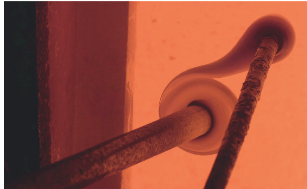
b. Enroulement du verre autour d'un ferret
