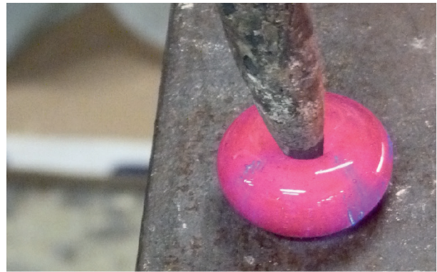
a. Formation d'une perle par percement d'une galette
