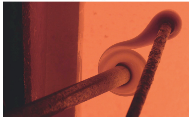
b. Enroulement du verre autour d'un ferret
