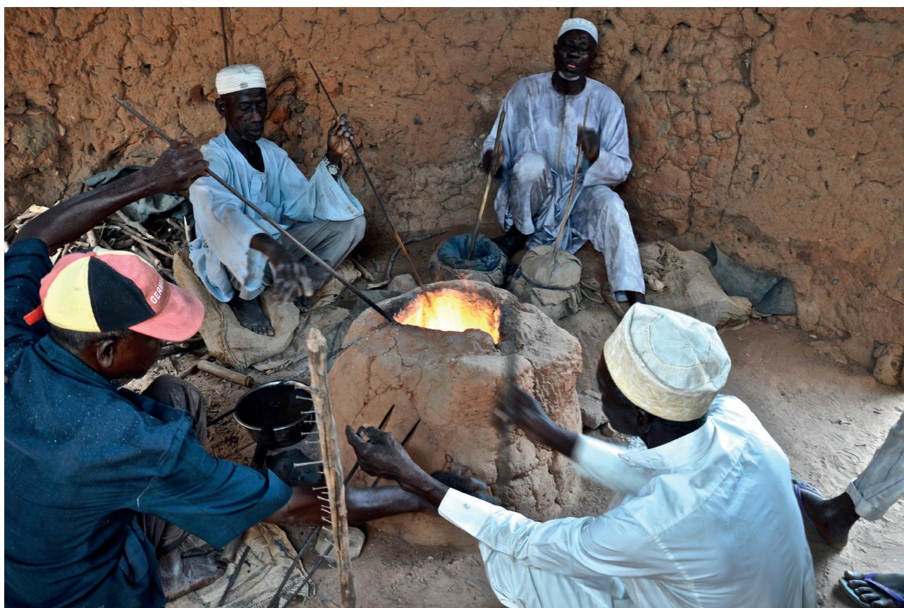
Fig. 3 – Artisans verriers de Bida, Nigeria. Autour du four, trois verriers fabriquent des bracelets tandis qu'un quatrième artisan actionne les soufflets pour obtenir une température suffisante. (Photographie L.Lababidi)
