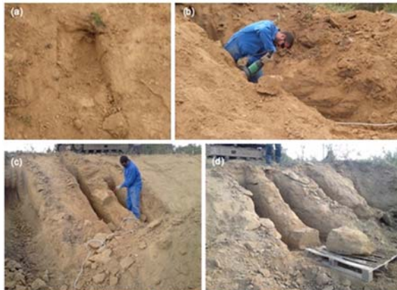
Figure 5. Tentative de récupération d'échantillon intact (a) à la tronçonneuse, (b) à la disqueuse, (c) à partir de deux tranchées de 30 cm de large espacées de 50 cm, (d) au perforateur perpendiculairement à la pente du talus.
