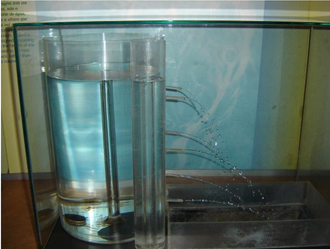
photographie d'un tonneau percé en train de se vidanger
