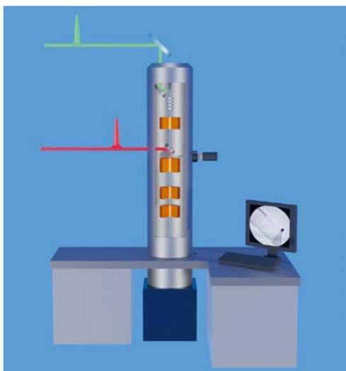
**Les microscopes électroniques en transmission ultrarapides combinent la résolution temporelle des sources laser femtosecondes avec la résolution spatiale des microscopes électroniques. Cette résolution spatio-temporelle inégalée, la richesse des techniques de microscopie électronique et les immenses possibilités de façonnage des impulsions optiques et électroniques ultrabrèves ouvrent des perspectives fascinantes pour l'exploration et le contrôle de la dynamique de la matière condensée.**
