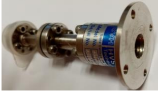
Figure 3 : L'antenne cornet corrugué disponible dans le banc CISTEME (bande W)
