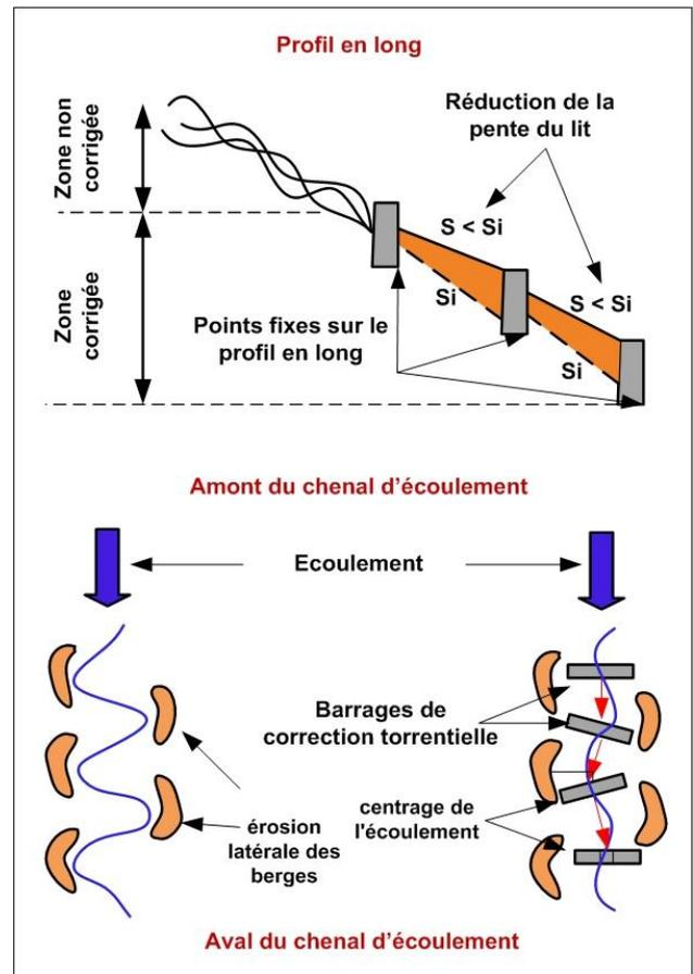
Fig. 2. Fonctions des barrages de correction torrentielle (d'après [7])
