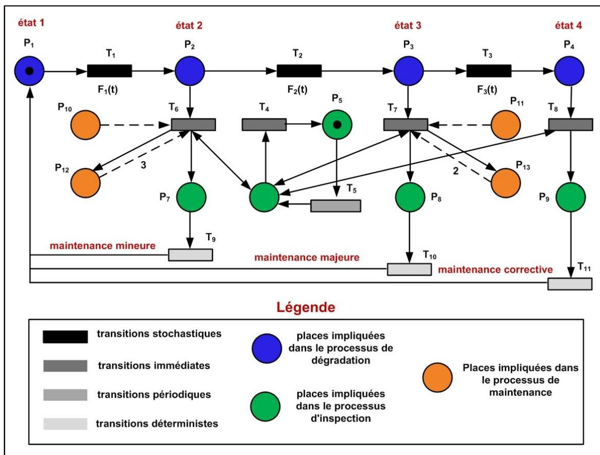
Fig. 4. Modèle RdPS intégrant les processus de dégradation, d'inspection et de maintenance.
