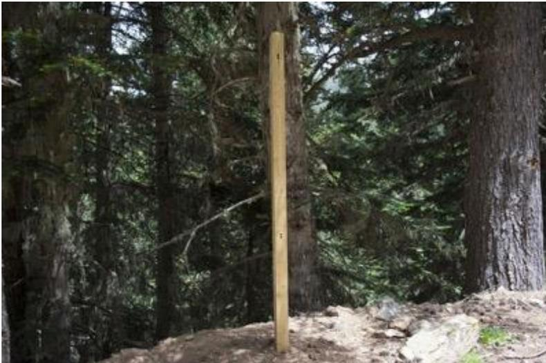
L'écomètre pyroélectrique infrarouge à lentille haute précision comptabilise, sur une piste du Canigó, les flux de 4 types d'usages différents — cliché V. Vlès, 2016.
