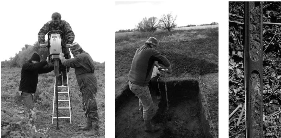
Fig. 3. Vue des techniques de carottages (tarière et carottier à percussion) et vue de détail du log 19 (carottage en gouge ouverte).
