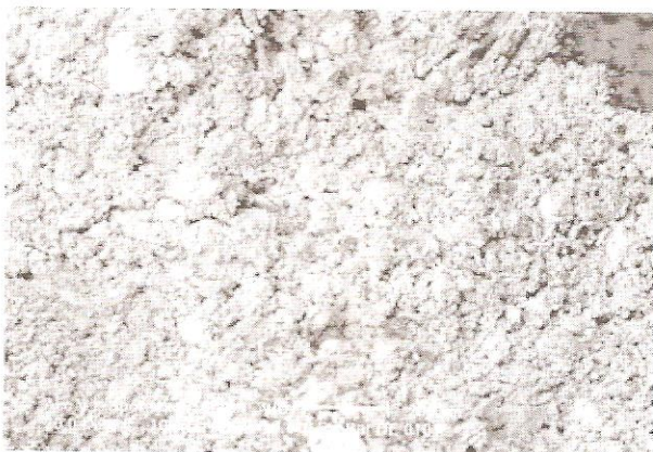
Fig. 2 – Brique faite de la terre de la plaine, de granulométrie plus fine. Détail grossi 105 fois. Photo D. Bagault, C2RMF, J. Menanteau, op. cit.
