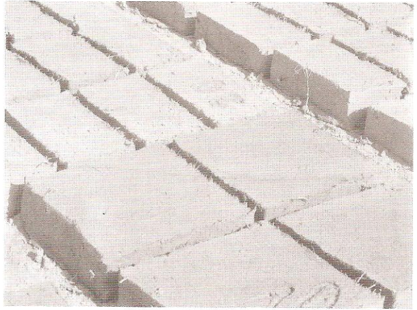
Fig. 8 – Les deux modules de briques, en cours de séchage à Doura-Europos : briques et demi-briques. Photo J. Humbert.
