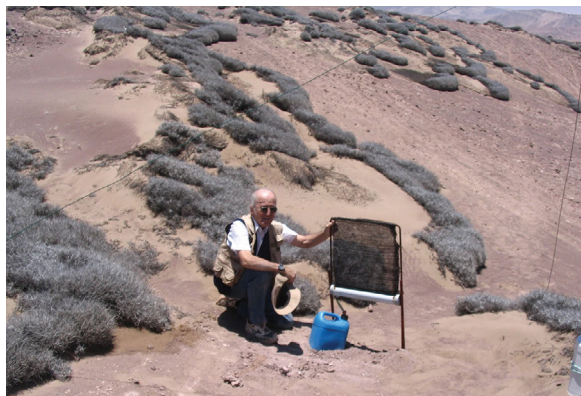
Figura 4. “Horacio Larrain midiendo un pequeño atrapanieblas de 50 cm x 50 cm en el sector más elevado de Cerro Guanaco (1.180 msnm)”. Fotografía de H. Larrain, Eco-antropología.blogspot.com
