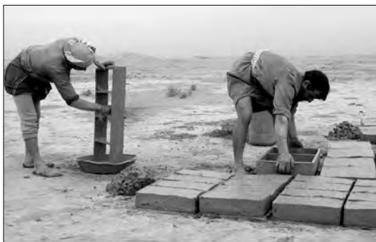
Fig. 11. Briques en cours de fabrication. À droite, démoulage de briques, à gauche, entretien rapide du moule (cliché MFSDE).
