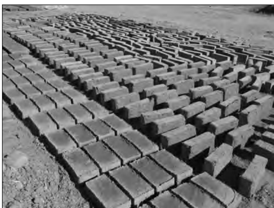
Fig. 12. Aire de séchage des briques. Au premier plan, demi-briques à plat qui viennent d'être moulées ; au deuxième plan, demi-briques déjà suffisamment sèches pour être placées sur la tranche afin d'accélérer leur séchage (cliché J. Humbert).
