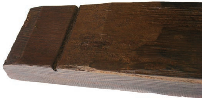
Fig. 20 – Le pas d'asse, le chanfrein, le jable et le rabotage d'une des rives (cliché : J.-J. Bigot).
