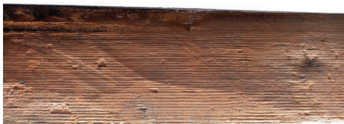
Fig. 19 – Traces de doloire à environ 45° sur le parement de la douelle OI 3765 (F378) (cliché : J.-J. Bigot).
