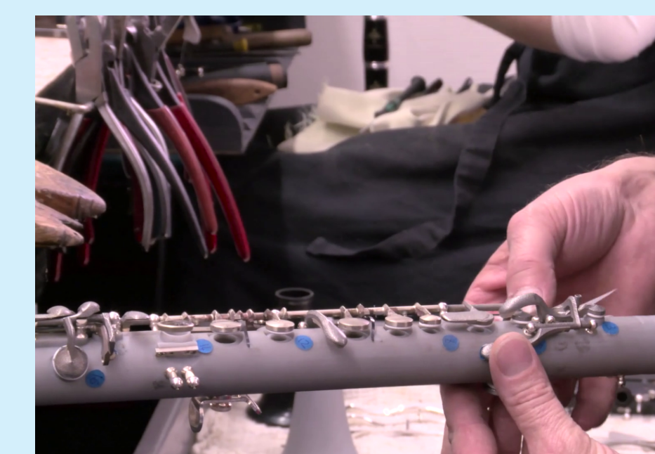
Clettage d'un prototype dans les ateliers Buffet-Crampon Thèse Alexis Guilloteau (2015)
