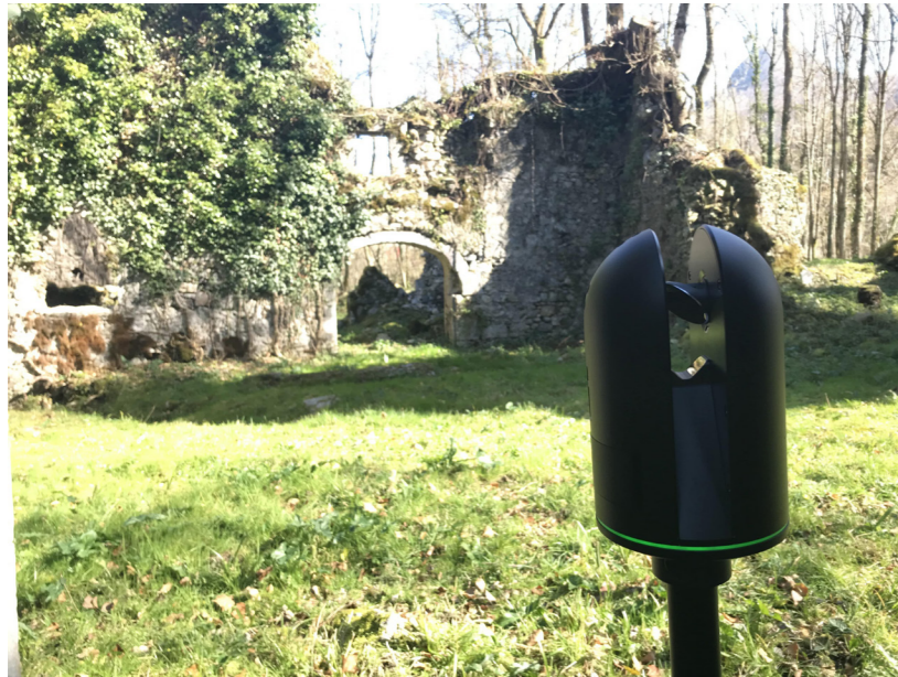
PHOTO DE LA NUMÉRISATION LASER SUR SITE LS2N-ECN
