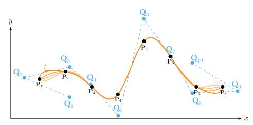
**Figure 6.** parametric cubic spline interpolated on fit knots with different tangent angles:  $\pi/2$  (—),  $\pi/4$  (—), 0 (—),  $-\pi/4$  (—),  $-\pi/2$  (—)
