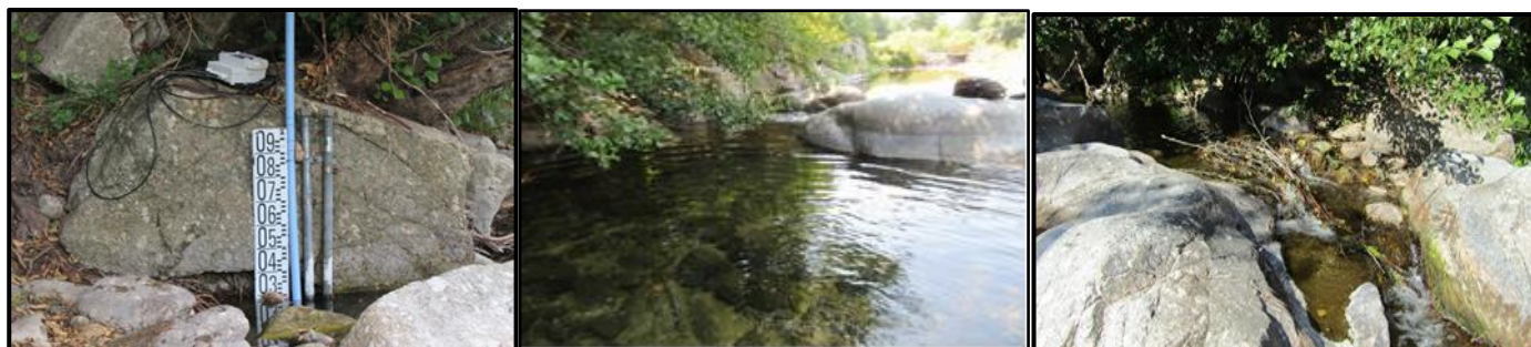
FIG.16 — STATION DE LASALLE SUR LA SALINDRENQUE AMONT, DURANT L'ÉTÉ 2019 — À GAUCHE ÉCHELLES ET SONDÉS ; CENTRE : SEUIL VERS L'AVAL — À DROITE, SEUIL OBSTRUE PAR BRANCHAGES DÉPOSÉS PAR UN CASTOR
