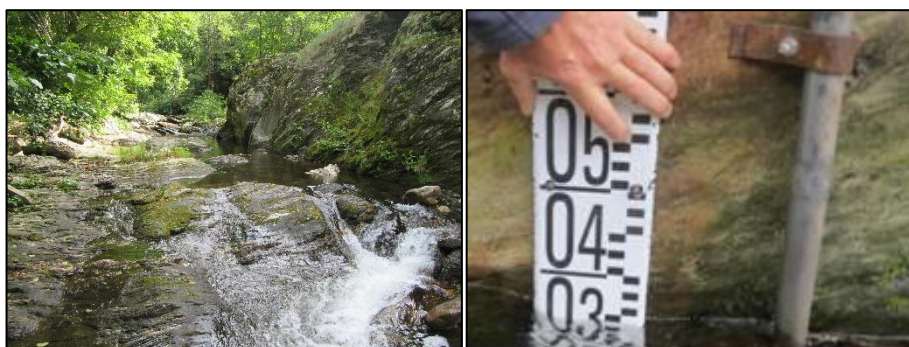
FIG.37 — STATION DE SAINT-ANDRÉ DE VALBORGNE ; GARDON DE SAINT-ANDRÉ AU PONT DE L'ELZE ; À GAUCHE LE SITE VU DE L'AVAL ; À DROITE, ÉCHELLE ET TUBE ABRITANT LA SONDE LEVELLOGGER
