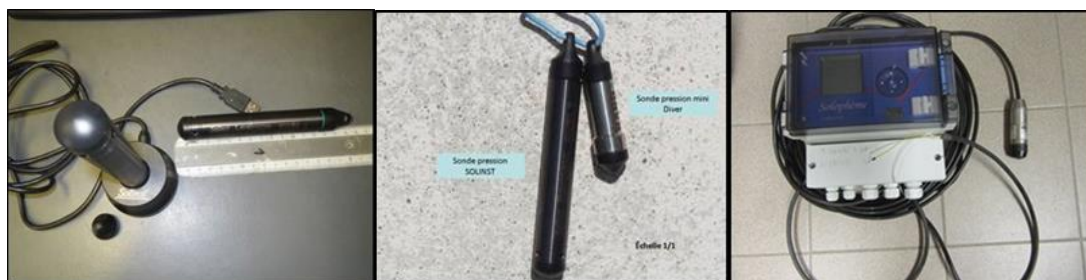
FIG.2 — SONDES SOLINST : LEVELLOGGER (DANS SON SABOT DE TRANSFERT DE DONNÉES) ET BAROLOGGER (GAUCHE), MINIDIVER (CENTRE) ; SONDE DE PRESSION KELLER ET CENTRALE SOLOPHÈME (DROITE)
