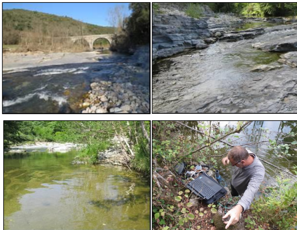
FIG.23 — STATION DE THOIRAS SUR LA SALINDRENQUE AVAL PRÈS DU PONT DE LA D 57 EN HAUT À GAUCHE ; POINT DE JAUGEAGE EN HAUT À DROITE ; PLAN D’EAU AVEC LA SONDE MINI DIVER ; RÉCUPÉRATION DU FICHER DE LA SONDE EN BAS À DROITE.
