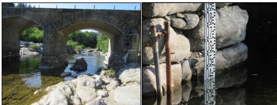
Le matériel se trouve à la base de la troisième pile du pont en partant de la rive droite. Du fait de la relative baisse des eaux à la fin du printemps 2019, l'installation a été réalisée le 15 mai, avec une hauteur d'eau cependant limite de 83 cm (2600 l/s).
