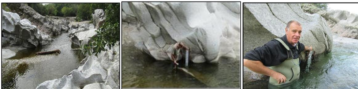
La courbe de tarage de la figure 70 est la combinaison du débit de la rivière au point de mesure augmenté du débit acheminé dans le *béal* connu ou estimé au moment du jaugeage. Depuis 2017, nous avons noté quelques niveaux lors des passages hebdomadaires, jaugeé le *béal* à plusieurs reprises, et pu ainsi construire une courbe d'étalonnage qui demanderait à être consolidée. Ainsi les débits fournis en 2017-2018 dans le cadre de ce travail sont-ils plus sûrs que les années précédentes.
