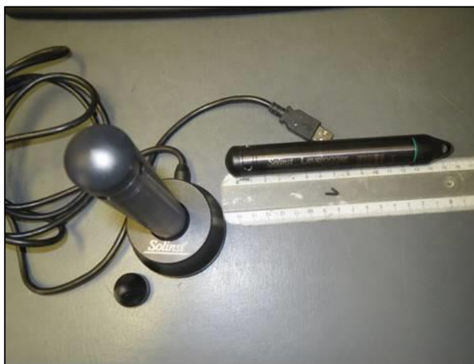
FIG.2 — SONDES SOLINST UTILISÉES POUR LA MESURE DES NIVEAUX D'EAU — SONDE LEVELLOGGER (DANS SON SABOT DE TRANSFERT DE DONNÉES) ET SONDE BAROMÉTRIQUE (PRESSION DE L'AIR)
