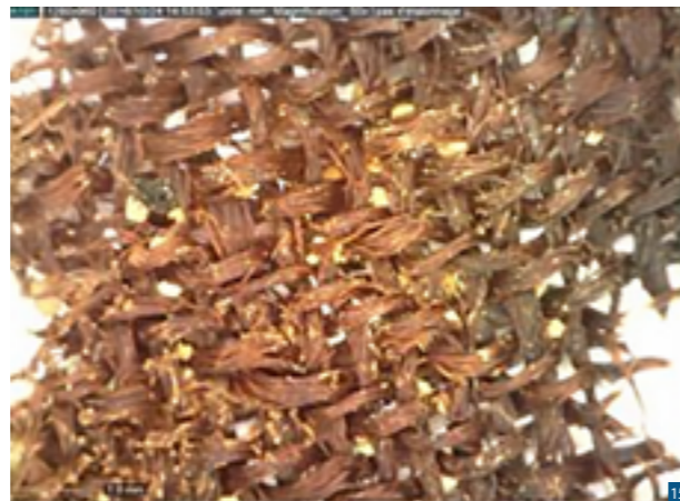
Observations au microscope optique d'un sergé irrégulier 2 lie 2 sergé 2 lie 1 tombe FONT 173. © Isaline Saunier.
