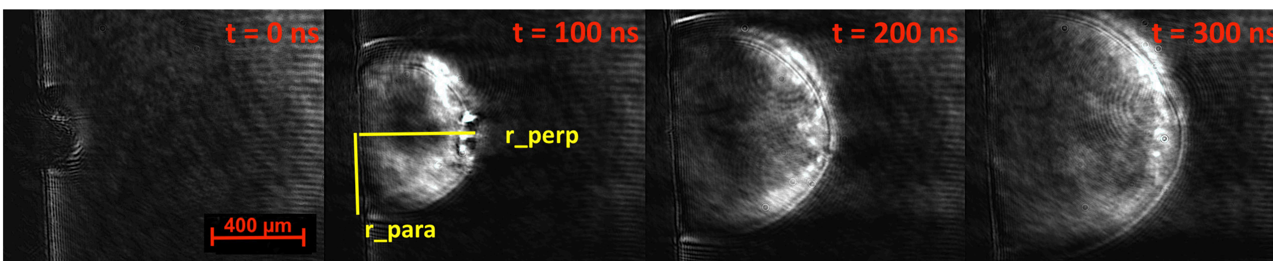
Clichés de suivi par imagerie Schlieren de l'expansion de l'onde de choc sur un échantillon de tungstène massif dans l'air.
