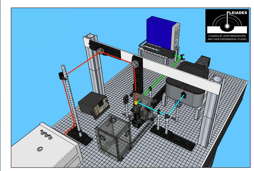
La **première impulsion** (1064 nm, 30 ps, 14 mJ) est focalisée pour former un plasma. La **seconde impulsion** (512 nm, 6 ns, 65 mJ) est focalisée dans ce plasma avec un décalage temporel Δt. L'émission radiative du **plasma réchauffé** est collectée le long d'un **troisième axe optique** en direction d'un spectromètre pour analyse.
