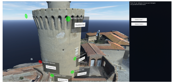
Figura 3: Front end di realtà virtuale per il monitoraggio dei dati raccolti mediante rete di sensori wireless e drone
