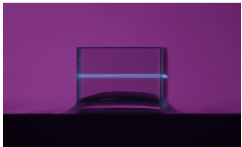
E2b. Fluorescence infrarouge de l'ion \text{Tm}^{3+} dans une matrice de \text{LiNbO}_3 . L'échantillon est en contact thermique sur son support grâce à une colle dont on aperçoit le ménisque. Le trait de fluorescence au centre apparaît flou, car il se superpose à sa réflexion sur la face arrière du cristal (c'est une sorte de « reflet de la physique » !).
