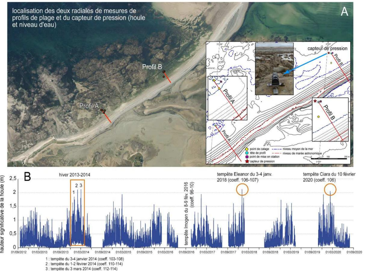
Figure 5.1 – localisation des deux profils de mesures topo-morphologiques et du capteur de pression de houle et de niveaux d'eau.
