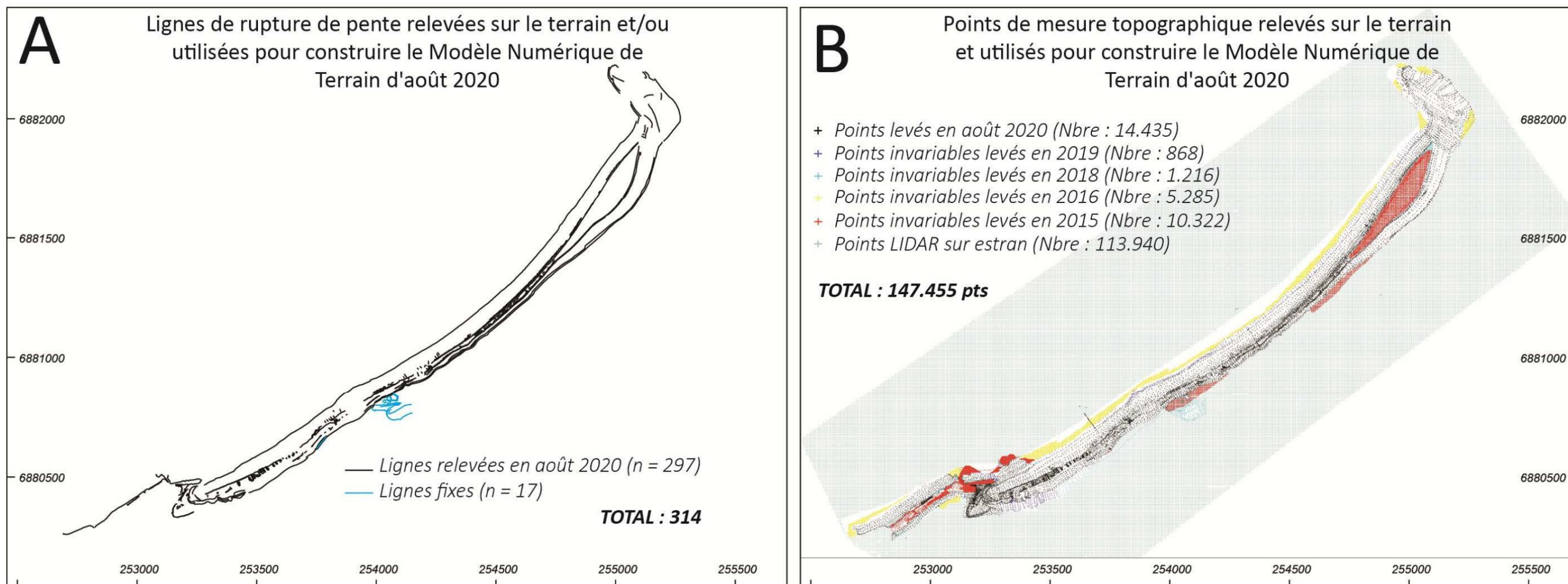
Figure 1 : Données topographiques utilisées pour construire les modèles de terrain d'août 2020 sur le Sillon de Talbert.
