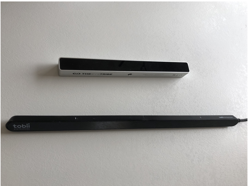
FIGURE 6: Deux des oculomètres qui permettent de jouer avec GazePlay : l’Eye Tribe en haut, le Tobii 4C en bas.
