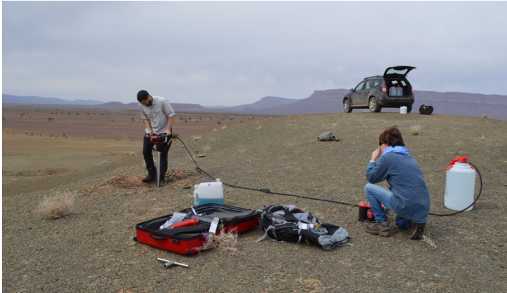
Fig. 4. – Forage à l'aplomb d'un site à préservation exceptionnelle du Trémadocien supérieur de la région de Zagora. L'analyse des carottes ainsi obtenues apporte de précieux renseignements sur le milieu de dépôt (faciès sédimentaires, géochimie) et l'âge des niveaux (analyses palynologiques). © Y. Candela
