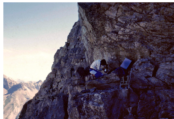
Fig. 8 et 9. Thermographes et sondes platine installés durant les années 1985 et 1986 sur le Roc noir, versant nord, à 3 000 m. Mesures en continu sur plusieurs niveaux entre la surface et 48 cm de profondeur (Ph. B. Francou).
