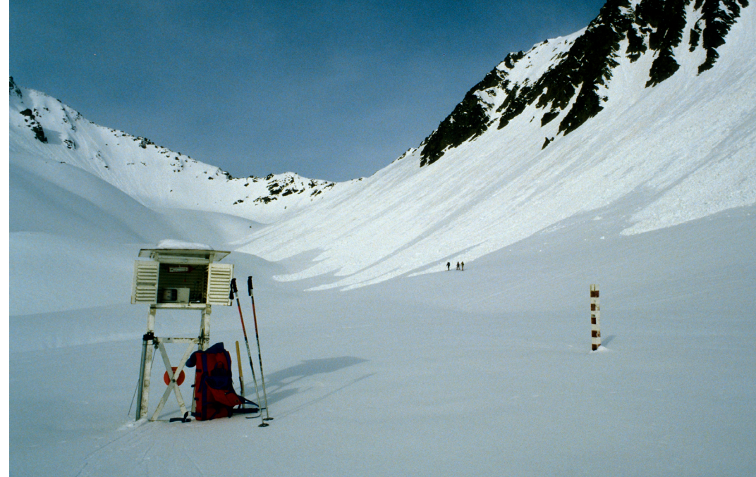
Fig. 6. Station thermographique de Laurichard installée à 2 450 m, avec l'une des deux perches à neige de 3 m, l'autre étant sur une éminence non visible à droite (ph. B. Francou).
