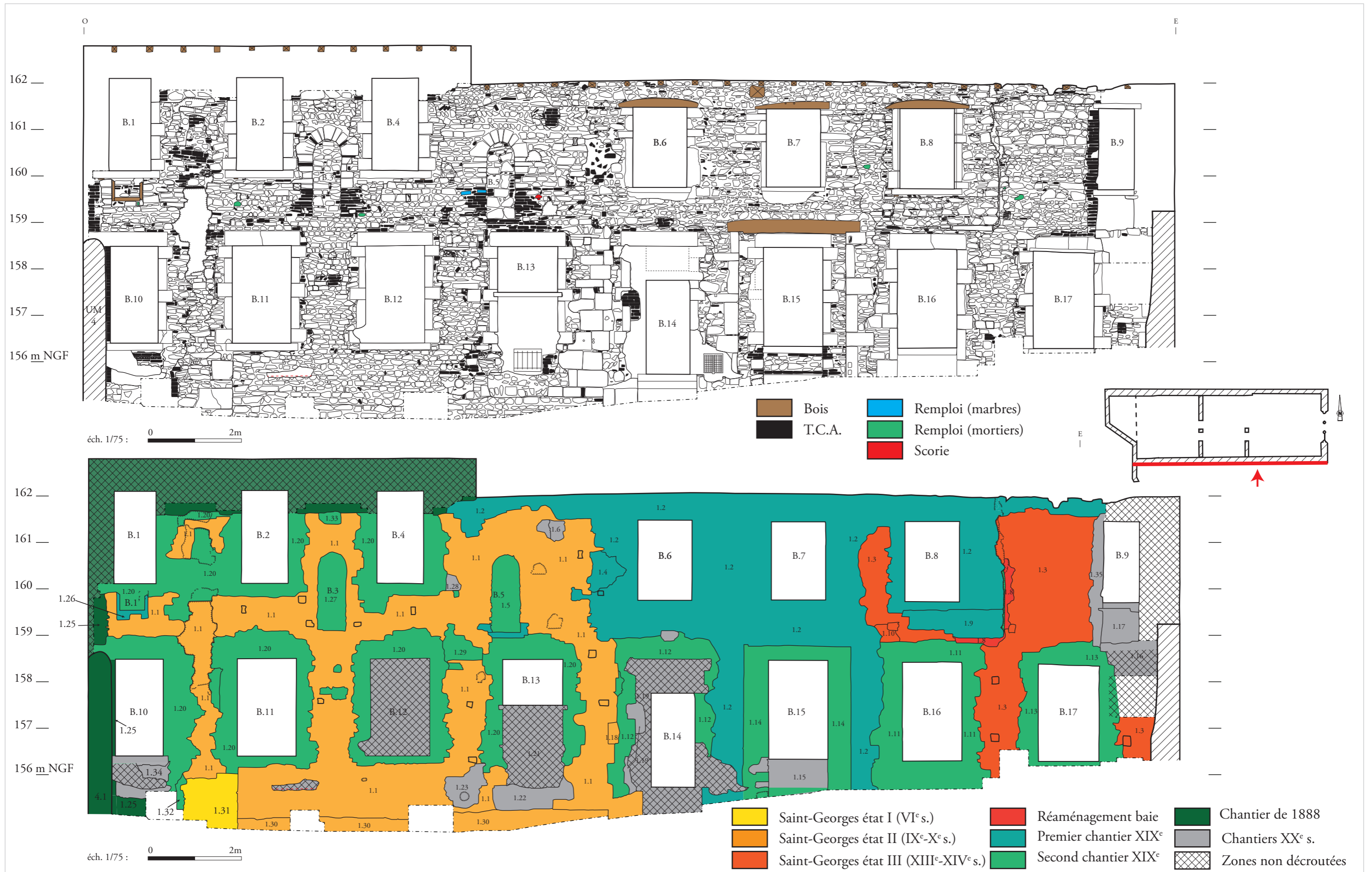
Figure 23 : Relevé et phasage du mur sud UM 1, éch. : 1/75 e ; Relevé & DAO : Quentin Rochet & Camille Collomb.
