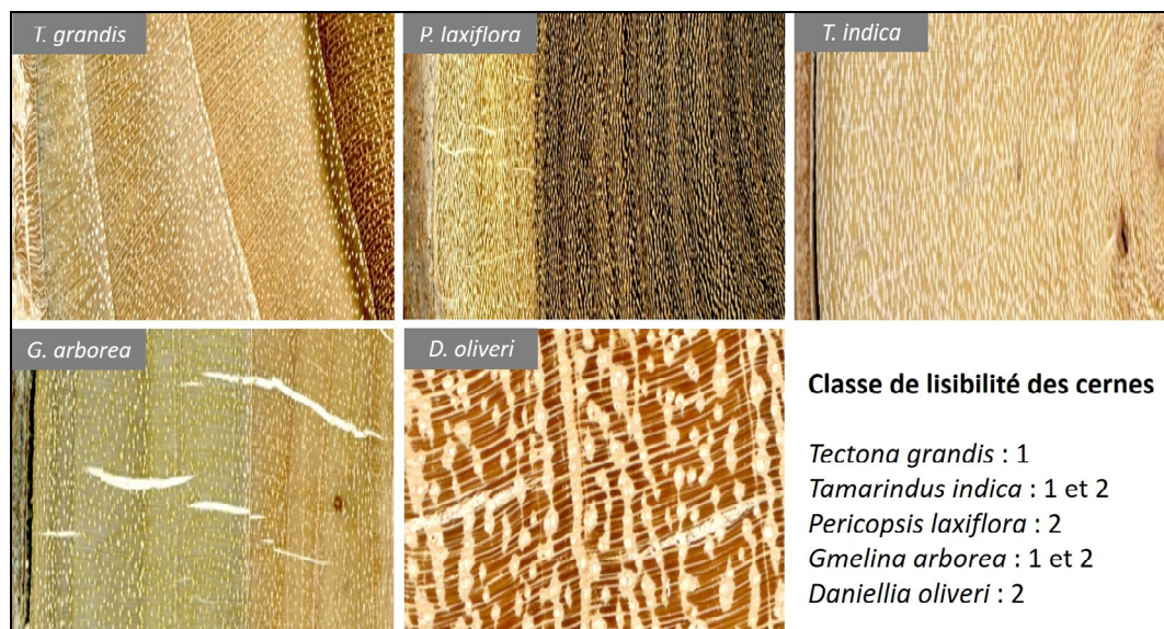
Figure 6 - Photographies des sections poncées des espèces de classe inférieure ou égale à 2 selon la classification de F. SCHWEINGRUBER (1992). [clichés : Soumaïla CONDÉ]
