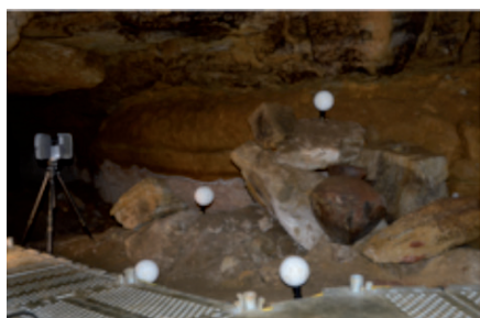
Figure 11. Numérisation d'une jarre de l'âge du Bronze in situ à l'aide d'un scanner laser Faro Focus 3D. Visualisation du nuage de points (milieu et droite).
