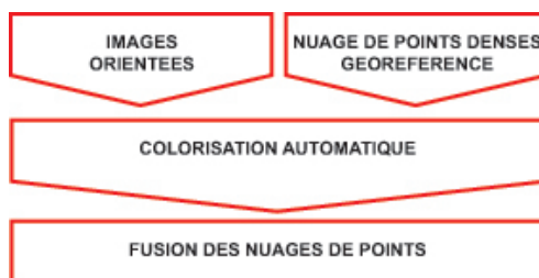
Figure 8. calcul des nuages de points colorisés à partir des images géoréférencées et orientées.
