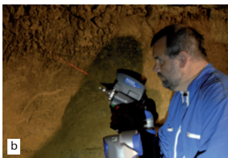
Figure 9. Numérisation d'un panneau orné du secteur 13 avec le scanner laser ScanArm de Faro ; a) Mise en place du scanner laser ScanArm ; b) numérisation du grand panneau orné du secteur 13 ; c) visualisation en temps réel des nuages de points.
