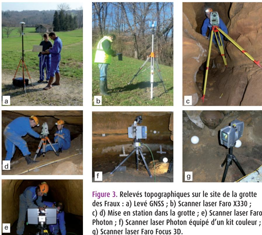
**Figure 3.** Relevés topographiques sur le site de la grotte des Fraux : a) Levé GNSS ; b) Scanner laser Faro X330 ; c) d) Mise en station dans la grotte ; e) Scanner laser Faro Photon ; f) Scanner laser Photon équipé d'un kit couleur ; g) Scanner laser Faro Focus 3D.
