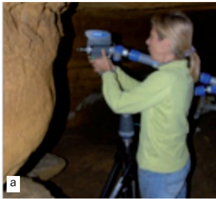
Figure 9. Numérisation d'un panneau orné du secteur 13 avec le scanner laser ScanArm de Faro ; a) Mise en place du scanner laser ScanArm ; b) numérisation du grand panneau orné du secteur 13 ; c) visualisation en temps réel des nuages de points.
