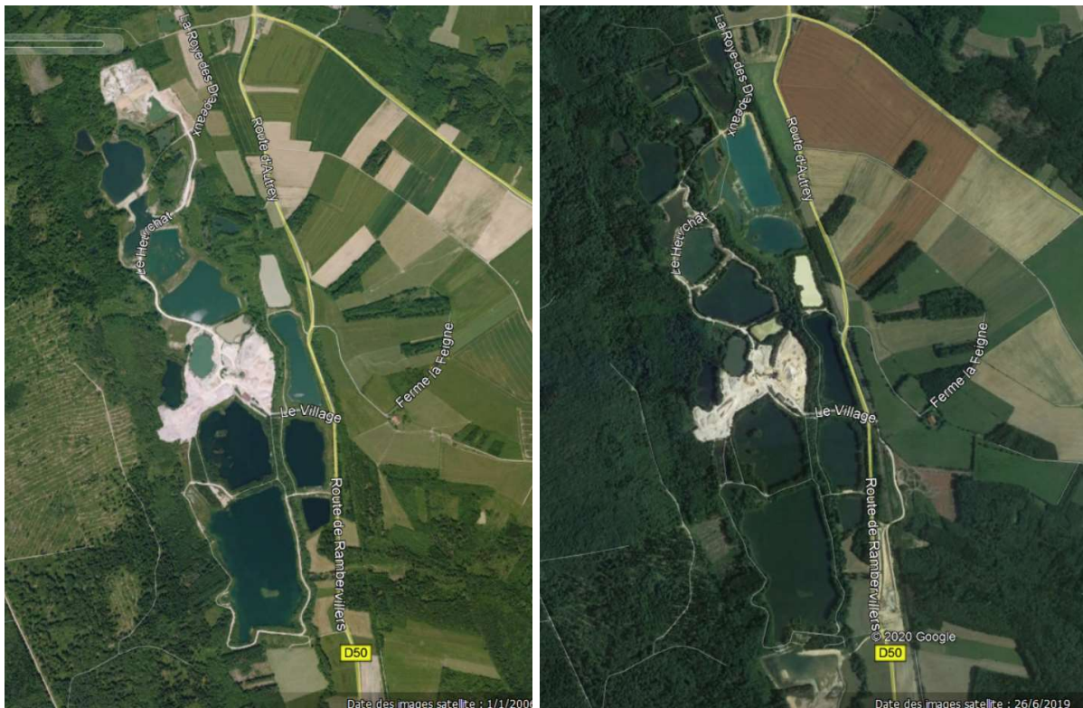
Evolution du site des gravières d'Autrey entre 2006 et 2019. On perçoit au centre le site de chargement et en périphérie nord puis sud les nouvelles zones d'extraction. Autour du site de chargement s'organisent par âge les sites reconvertis. Images Google Earth.
