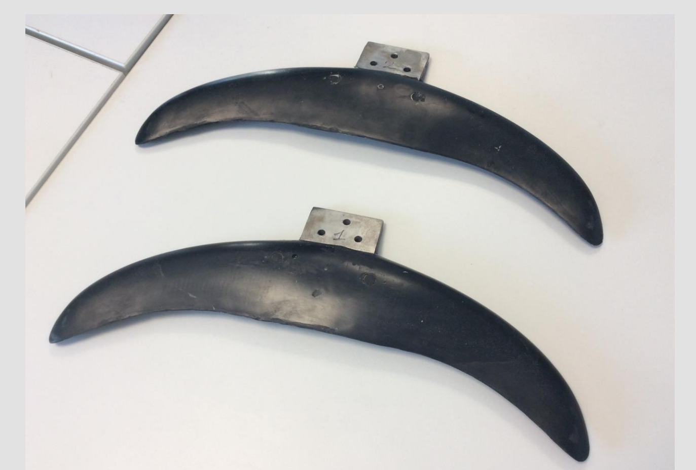
Foils asymétriques souple pour la sustentation (Fabrication IUT Nîmes)
