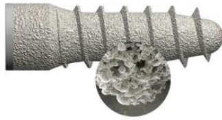
Figure. 75. Exemples de fonctionnalisation de surface d'implant par procédé DED
