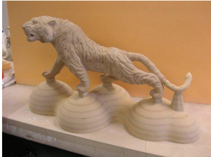
Figure. 46. Exemple d'un outillage modèle pour coulée en pâte de verre (Crédits Cirtes)
