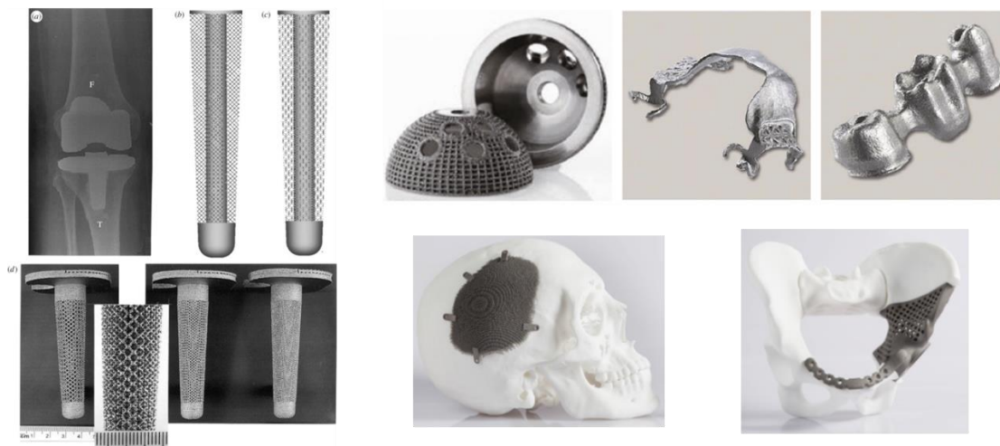
Figure. 72. Exemples de dispositifs médicaux métalliques réalisés par PBF [89], [93]
