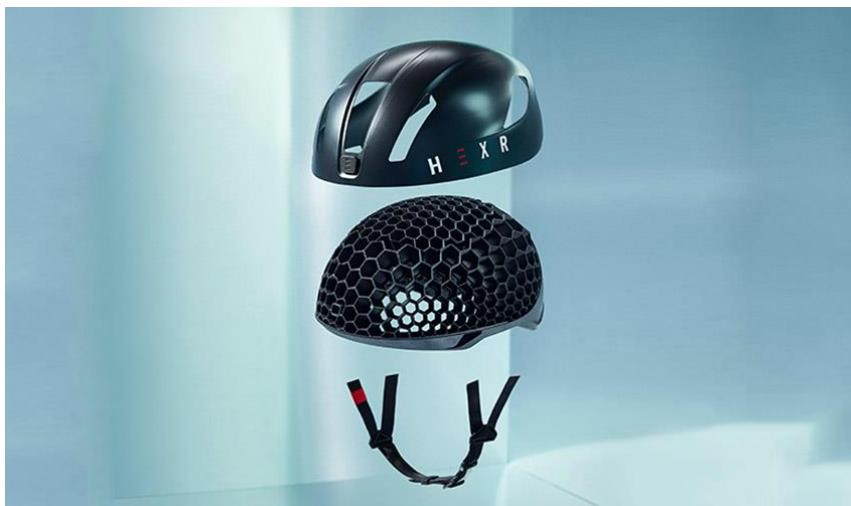
Figure. 41. Illustration de la complexité hiérarchique rendue accessible par la fabrication additive : structure alvéolaire à motifs nid d'abeille d'un casque de vélo (Crédits 3D Natives ; HEXR)
