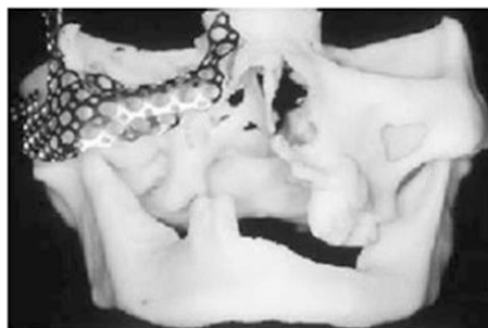
Figure. 80. Gabarit d'ajustage individualisé d'un implant maxillo-facial
