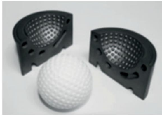
Figure. 13. Exemple d'un outillage rapide direct de moule en acier [92]
