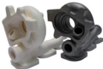
Figure. 14. Exemple d'un outillage rapide indirect à gauche un modèle de pièce réalisé par projection de PMMA, à droite la pièce en alliage métallique obtenue par fonderie à modèle perdue [92]
