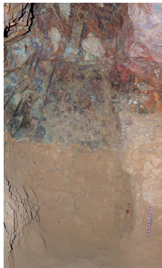
Fig. 32. Front de taille en gradins inversés dans la galerie fouillée à proximité du puits 2 (© MAFDO, F. Téreygeol, 2014).
