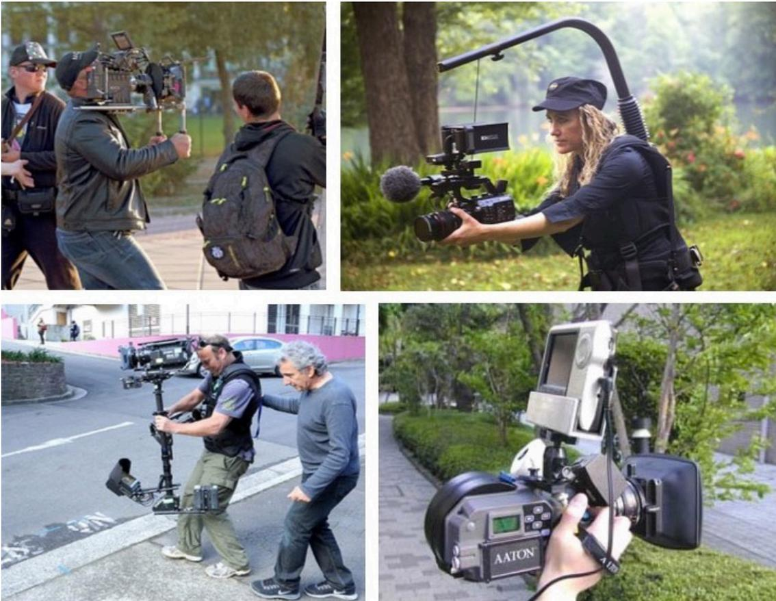
Figure 3 : faire « corps » avec la caméra (caméra avec cross-épaule ; Blaire Johnson avec un *Easyrig* ; caméra sur *Steadicam* ; caméra de « poing » A-Minima d'Aaton).
