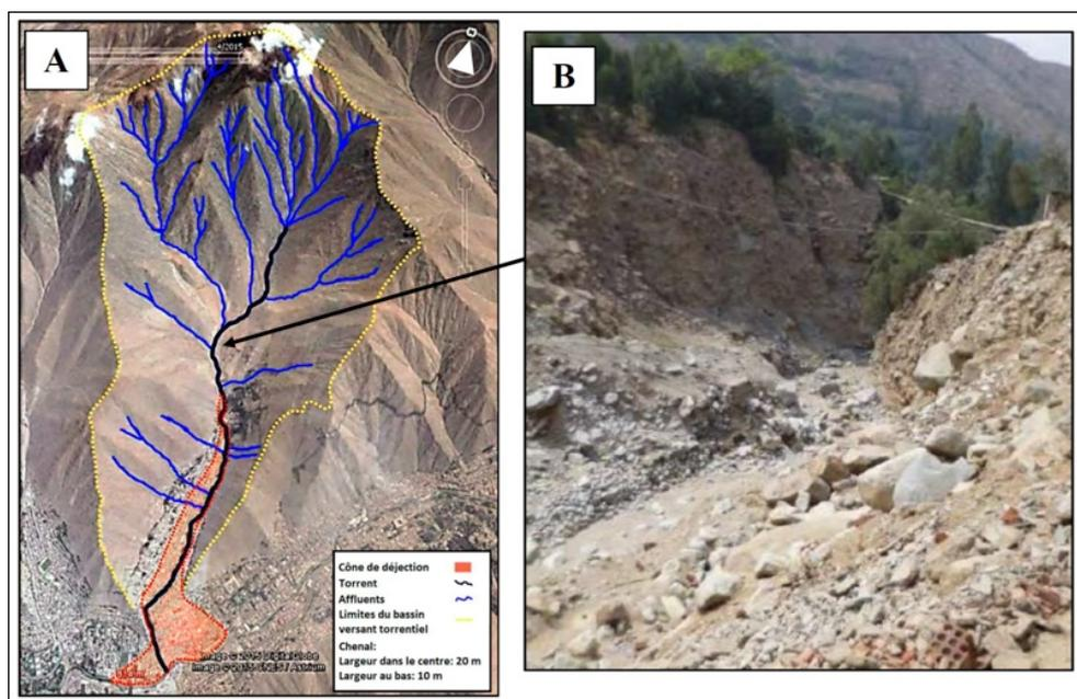
A : Bassin-versant du torrent Pedregal, ses affluents et le cône de déjection.
