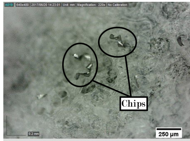
(d) SLM alloy - f_t = 4.0 \mu\text{m}/\text{tooth} .
