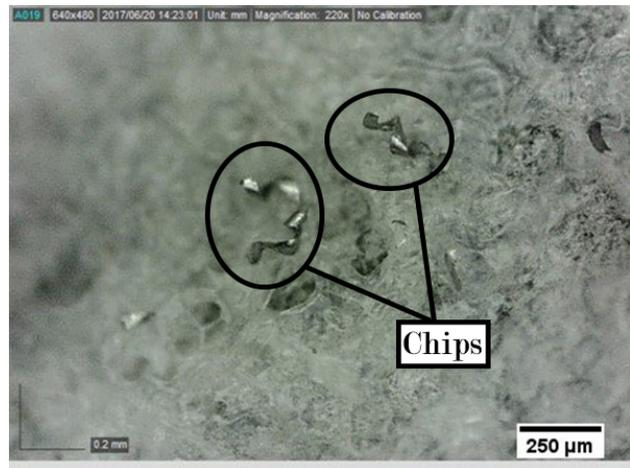
(d) SLM alloy -  $f_t = 4.0 \mu\text{m}/\text{tooth}$ .
