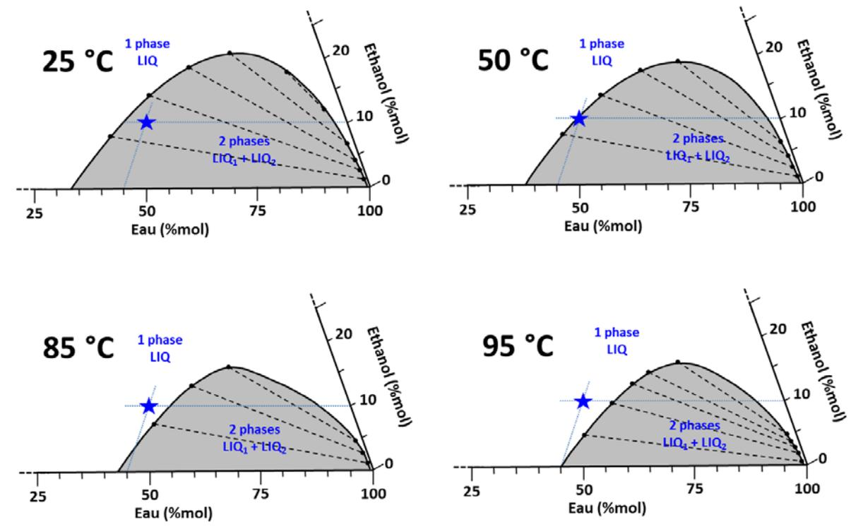
Figure 8. Equilibres Liquide-Liquide dans le système ternaire Eau-Ethanol-Pentanol, en fonction de la température sous pression atmosphérique, figure adaptée d'après [10].
