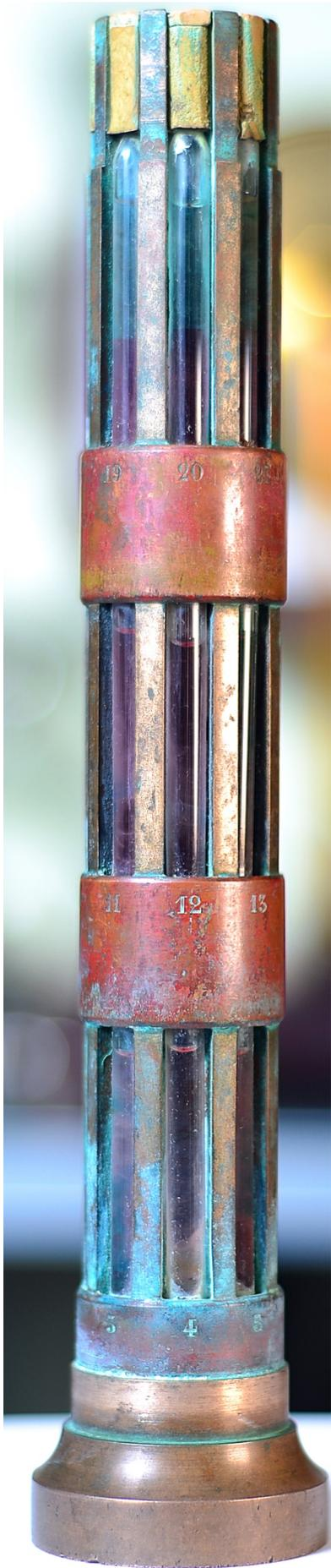
Figure 4. Le thermomètre, sans le cylindre en laiton de protection, montrant l'empilement des tubes scellés le long du corps cylindrique en cuivre (© Vincent Noclin – Université de Lyon).
