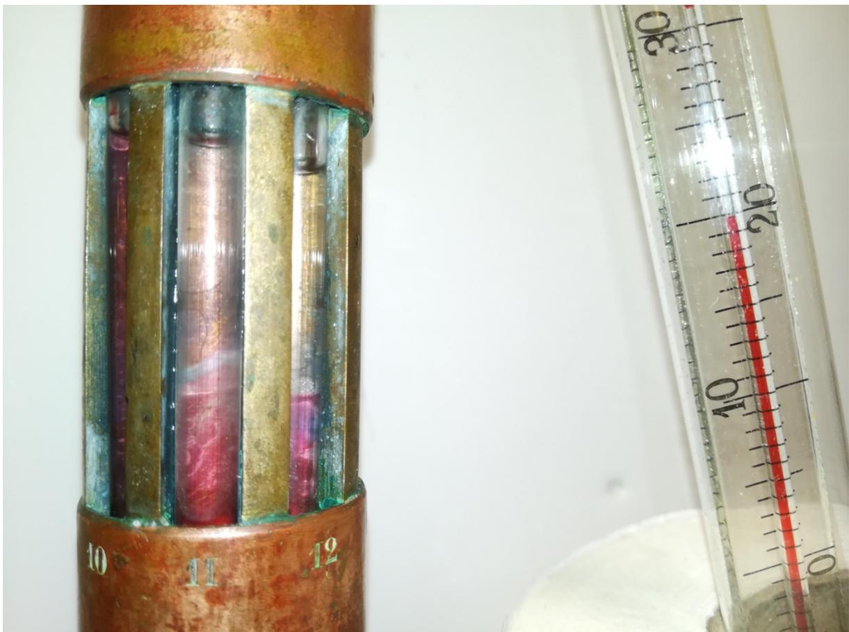
Figure 9. Observations des tubes scellés du thermomètre à *minima* de Duclaux (gauche) après avoir été immergé dans un liquide à 10°C, puis laissé 1h à température ambiante dans la pièce (20°C). La température de la pièce est mesurée par un thermomètre à capillaire (droite).
