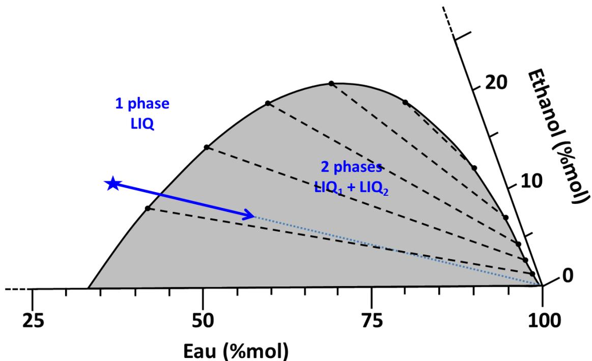
Figure 6. Equilibres Liquide-Liquide dans le système ternaire Eau-Ethanol-Pentanol, à 25°C sous pression atmosphérique, en fonction de la composition du mélange, figure adaptée d'après [10]. Les traits noirs pointillés illustrent les équilibres biphasés entre deux phases liquides LIQ<sub>1</sub>+LIQ<sub>2</sub>, l'une riche en eau, l'autre riche en alcools (pentanol et éthanol).
