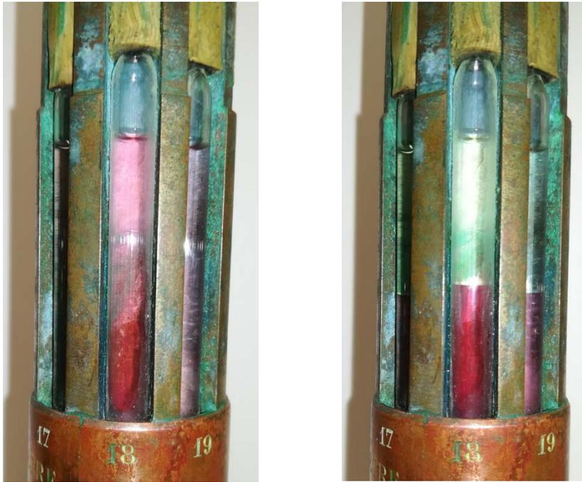
Figure 7. Photo du même tube scellé (18°C) avant démixtion (Gauche) et après démixtion où l'on observe les deux liquides qui ont démixé (Droite).
