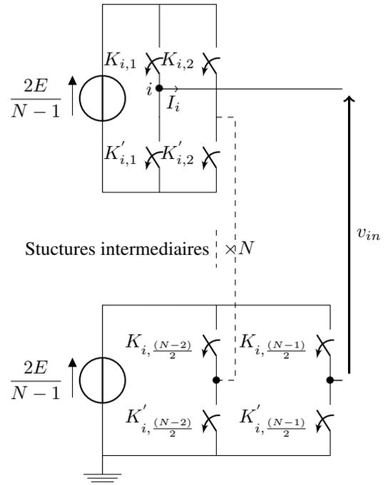
Fig. 4. Bras isolé d'un onduleur de type H-bridge.
