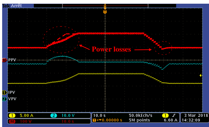
Fig. 15. Variations de P_{pv} , V_{pv} et I_{pv} lors de la fluctuation de l'irradiation solaire en utilisant un P&O
